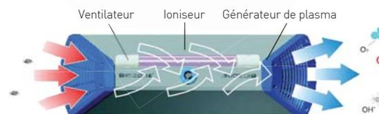
Une fois dispersés dans la pièce, le plasma d'oxygène et les ions négatifs générés se chargent de purifier l'air qui n'a donc pas besoin de transiter par l'appareil pour être traité.
